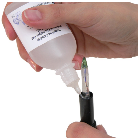
Uzupełnianie elektrolitu żelowego w kołnierzu elektrody
